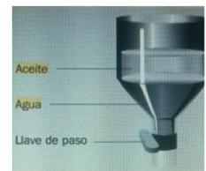
Echamos la emulsión en un “embudo de decantación” y la dejamos reposar hasta que el agua se deposite en la zona inferior y el aceite en la superior (la densidad del agua es mayor que la del aceite) los embudos de decantación tienen el cuello muy estrecho.
